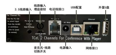
参考上图示意,两通道会议机型的接口和调节区。从左到右分别是用于输入 微弱到普通信号的 3.5mm 插孔和对应的增益旋钮: 逆时针或顺时针调节 GainADJ 电位器可在 1-30 的范围调节针对 3.5mm 信号源的增益,当调节到左 极限时增益为 1,对应标准强度的线路输入信号。注意 3.5mm 连接器的信号内 部连接到 RJ11 的 1、4 芯。
