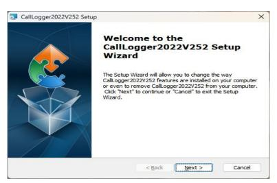
根据屏幕提示,安装录音管理软件。安装好软件后,将录音设备接通电源, 并用方口 USB 数据线与 PC 机连接。后点击"Call Logger.exe"。
